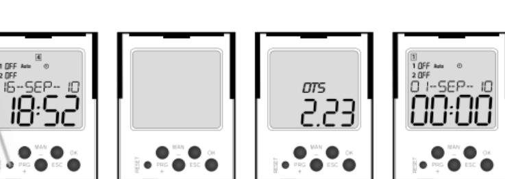
Извършва се с кратко натискане с тъп шил (например химикалка или отвертка с диаметър макс. 2 mm) на скритото бутонче RESET.
