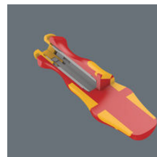
Rękojeść z uchwytem do trzpieni wymiennych przeznaczona jest wyłącznie do trzpieni wymiennych firmy Wera. Rękojeść Kraftform Plus zapewnia przyjemną i ergonomiczną pracę chroniąc dłoń przed powstawaniem pęcherzy i odcisków. Twarde strefy chwytu umożliwiają szybką pracę, miękkie strefy zapewniają przenoszenie wysokich momentów obrotowych.
