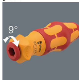
Drobnozębny mechanizm zapadkowy w rękojeści (40 zębów) i kąt powrotu zapadki 9° umożliwiają łatwiejsze i szybsze dokręcanie bez konieczności ponownego nasadzania narzędzia.
