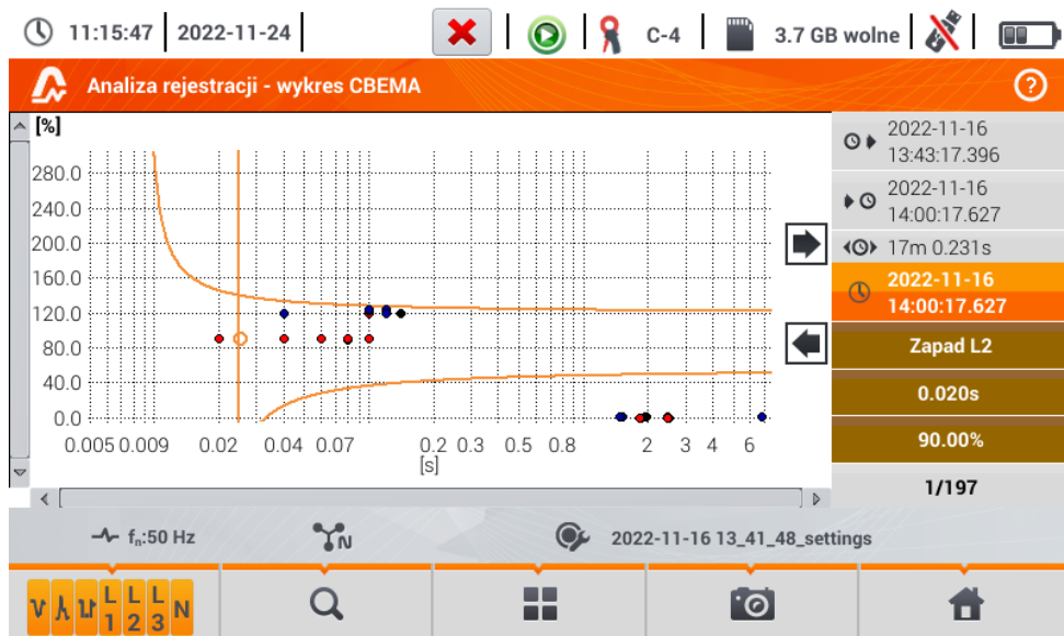
Rys. 5.27. Analiza rejestracji - wykres CBEMA
