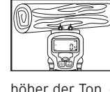
Stecken Sie die Messspitzen in das zu überprüfende Material (z.B. Holz), und lesen Sie den Wert im Anzeigefenster ab. Zusätzlich ertönt ein akustisches Signal. Umso höher der Ton, desto höher der Feuchtigkeitsgehalt.
